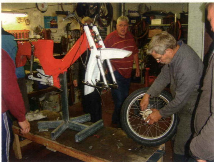
Heikki Salokannel asentaa etupyörää Tunturi Startin haarukkaan.
